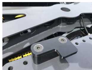
Stabila invändiga låsningar håller flaket låst i alla lägen
