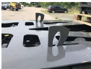
Rangeringsstoppar som bromsar flak i låsläge
