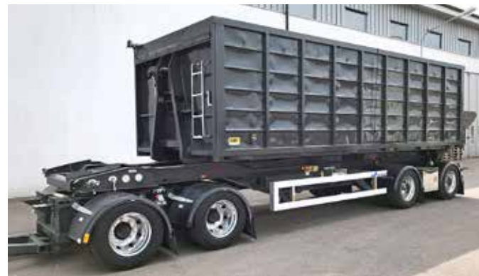
Parators nya lastväxlarvagn för en bruttovikt på upp till 38 ton. Ett skjutbart flaklås ger förutsättningar för rätt N-värde och axeltrycksfördelning. Tjänstevikten är 6.500 kilo.
