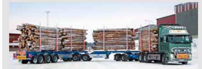
Det FH16-ekipage, med link och trailer från Parator, som banade vägen för alla HCT-projekt. Med en bruttovikt på upp till 90 ton rullade det i över 100.000 mil innan det pensionerades.
