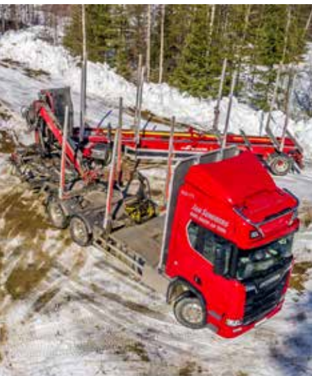
Jan Sundbergs Åkeri från Erikslund vänder i skogen med det Scania 580 - ekipage där den fyraxliga Parator-vagnen är specad för en bruttovikt på 38 ton.
